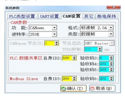
把程序下载到 PLC 主机,PLC 的 CAN-H,CAN-L 与模块的 CAN-H,CAN-L 相连,直接插上排线也可以,注意:每次只能标定一块模块,标定模块时其它的模块不能连在 CAN-H,CAN-L 上。
