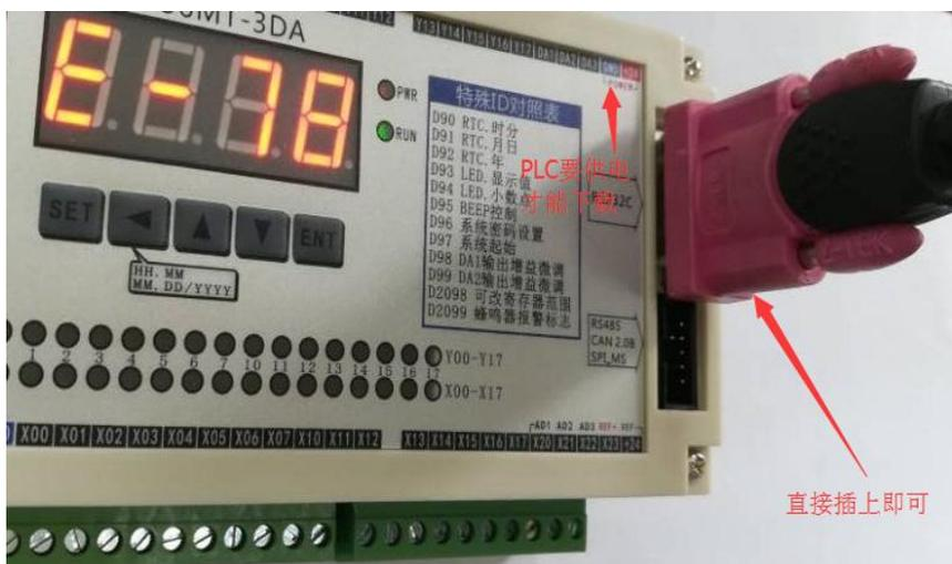
如果端口设置正确就可以顺利将程序下载到 PLC 中，出现以下图标
